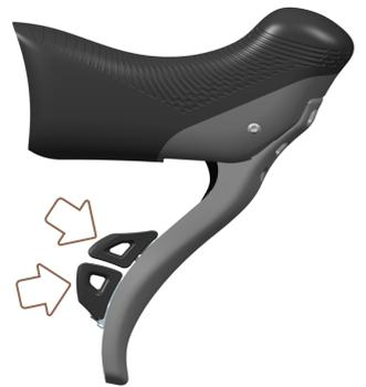
2) Halten Sie gleichzeitig die MODE-Tasten des rechten und linken Ergopower Schaltgriffs etwa 5 Sekunden gedrückt, bis die ROSA LED aufleuchtet. Drücken Sie innerhalb 1 Sekunde die MODE-Taste des rechten Ergopower Schaltgriffs. Die LED des Schaltwerks leuchtet dauerhaft ROSA.
