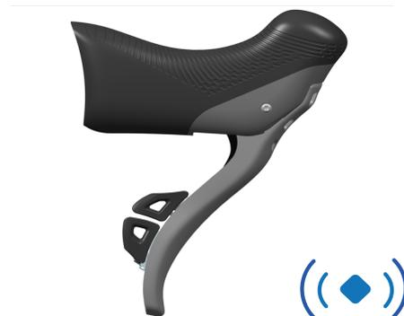
Die LEDs der Schaltgriffe blinken mit hoher Frequenz (blaue Farbe), um die mangelnde Kopplung anzuzeigen.
